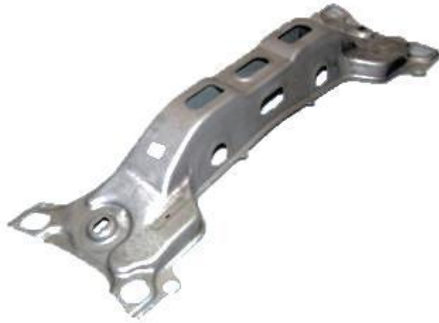
Figura 3.3. Travesaño trasero en HSLA 300 revestimiento Extragal
