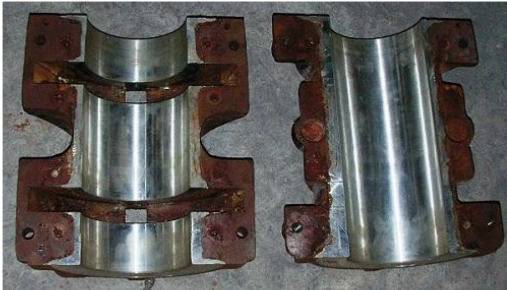
Figura 12.1. Chumacera recubierta con Babbitt
