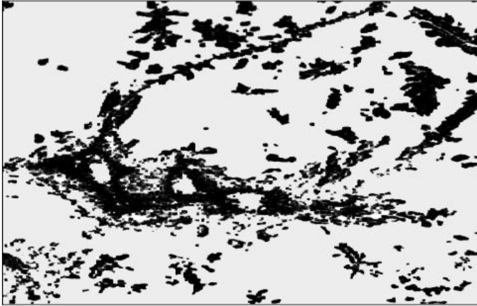
Figura 2.2. Microestructura acero Hadfield grado A, atacado con picral 4% 100X. Se observan granos de austenita (claro) con carburos precipitados (oscuro) Fuente: [1] G. Aggen et al. , ASM Handbook: Properties and Selection: Irons, Steels, and High Performance Alloys . 10th ed. Vol. 1. USA: ASM International Handbook Committee 1993
