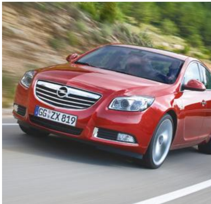
Figura 4.3. El Opel Insignia fue elegido Coche del Año 2009. Este modelo obtuvo 35 de los 37 puntos posibles en las pruebas de Euro NCAP, lo que le valió las valiosas 5 estrellas en protección del pasajero. El refuerzo de talonera del Opel Insignia está realizado con Docol 900 M con superficie ZE. Las piezas estructurales del techo y del suelo están fabricadas con Docol 980 DP.
