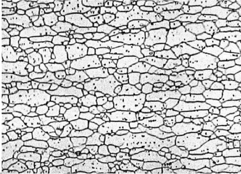
Figura 3.1. Microestructura de un acero HSLA 340 laminado en caliente
