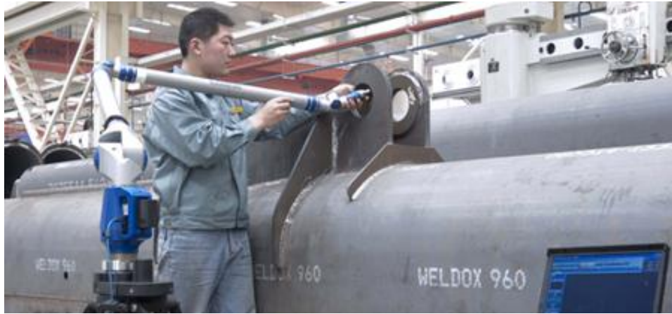
Figura 4.4. La empresa Xuzhou Heavy Machinery Company, que forma parte del grupo XCMG, ha experimentado un notable crecimiento durante los últimos 20 años y hoy exporta grúas móviles a 90 países de todo el mundo. La clave del éxito es el acero Weldom®. Para sus gigantescas grúas, que alcanzan alturas de hasta 100 metros, la empresa usa una combinación de Weldom 700/ 900/ 960 y 1100
